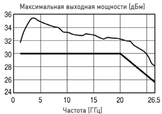
Максимальная выходная мощности усилителя 83020A
